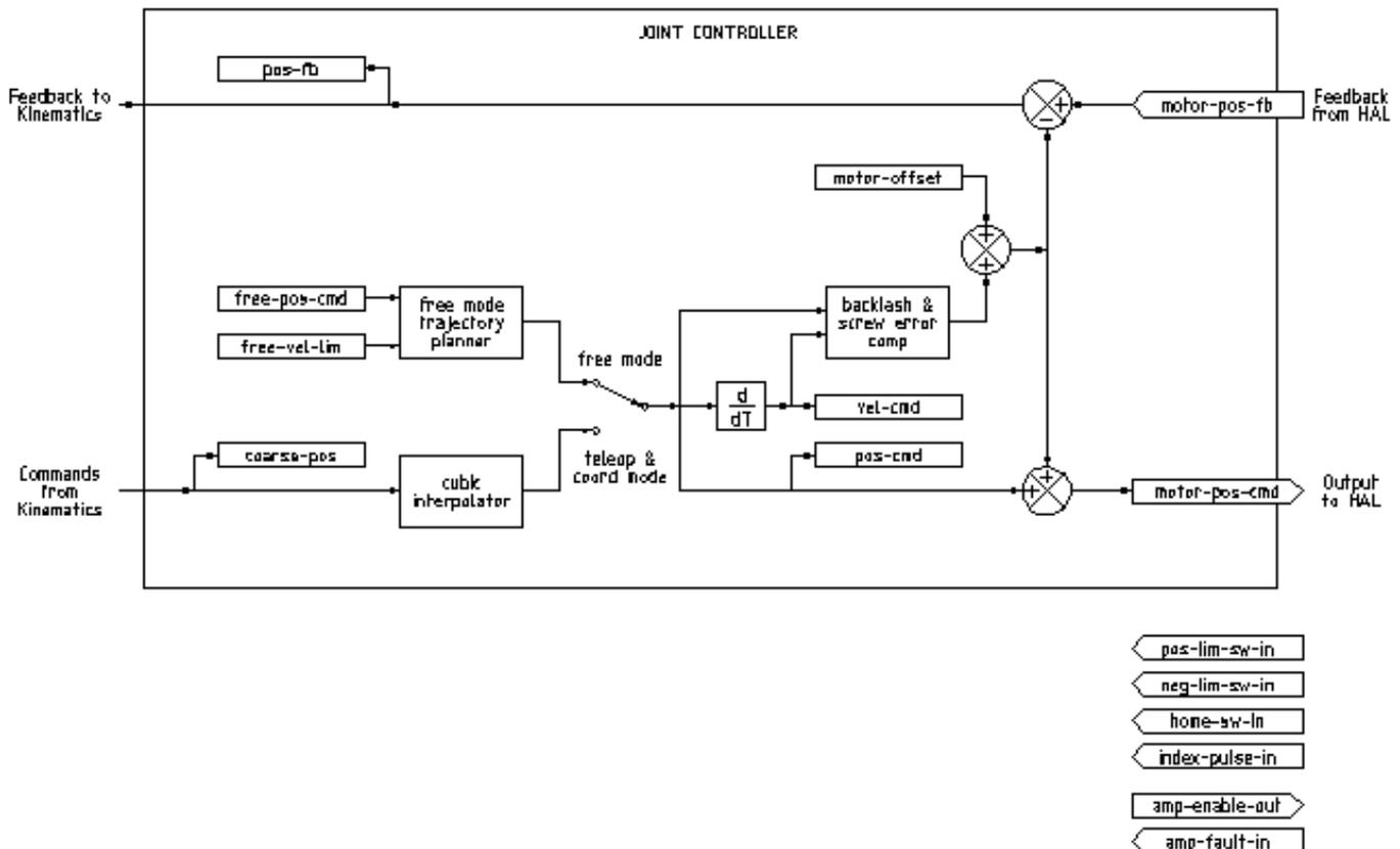
Abbildung 3.1: Blockdiagramm des Joint Controllers
