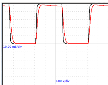
Figure 2.29: Intégration à 20 Hz. R = 1\text{ k}\Omega et C = 1\text{ }\mu\text{F}
